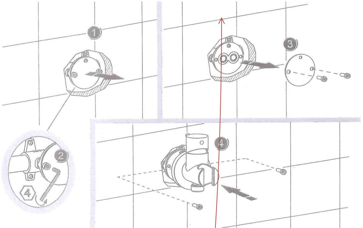
1- MONTAR LA PARTE EMPOTRADA Y PONER EL AZULEJO. RESPETAR LAS INDICACIONES DE NIVEL MINIMO DE AZULEJO ESPECIFICADAS EN LA PIEZA.
